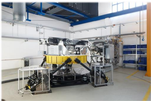
Multiaxiale Schwingungs- prüfung mit Heißgas
