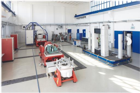
Elektromechanische Shaker 9 bis 60 kN
