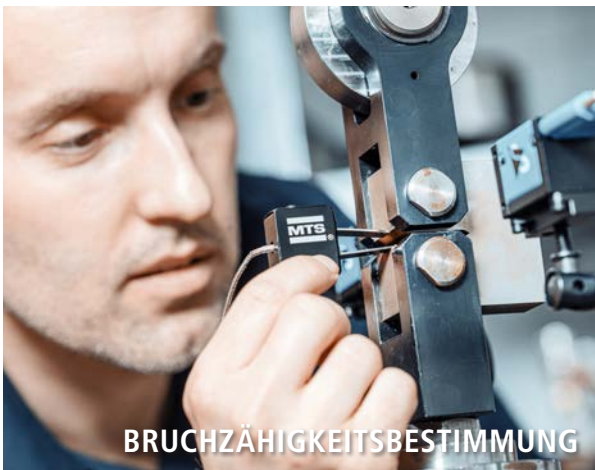
C(T)-PROBE NACH ASTM E1820
