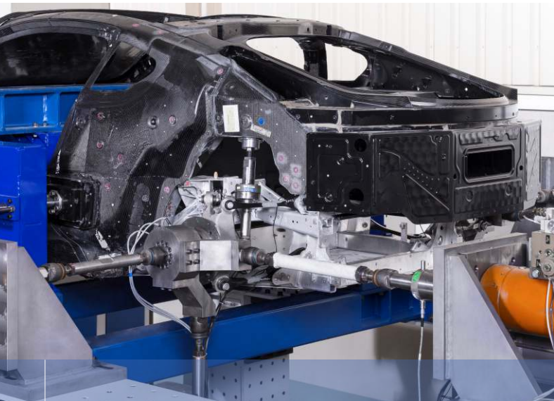
Betriebslastensimulation CFK-Karosserie - BMW i8
